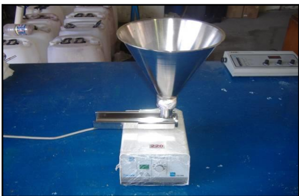
Figura 9 – Alimentador de sólidos, Laboreto
