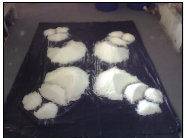
Figura 5 – Foto da aplicação da técnica de quarteamento
