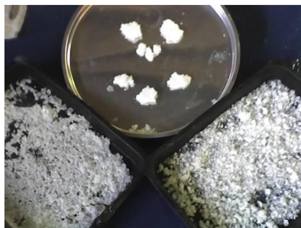
Figura 6: Aspecto do Sal Seco Após Processo de Secagem em Estufa.
