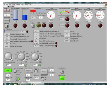
Figura 7. IHM desenvolvida para o loop de escoamento de fluidos de perfuração.
