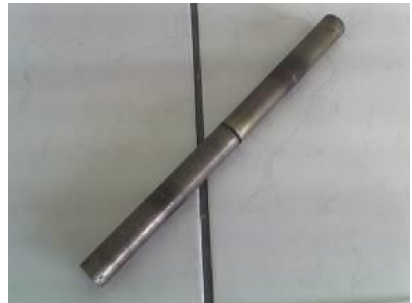
Figura 7 – Material Poroso Constituído de Aço Inox Sinterizado.
