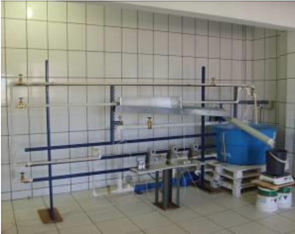
Figura 4 – Foto da Unidade Experimental de Filtração Cruzada.
