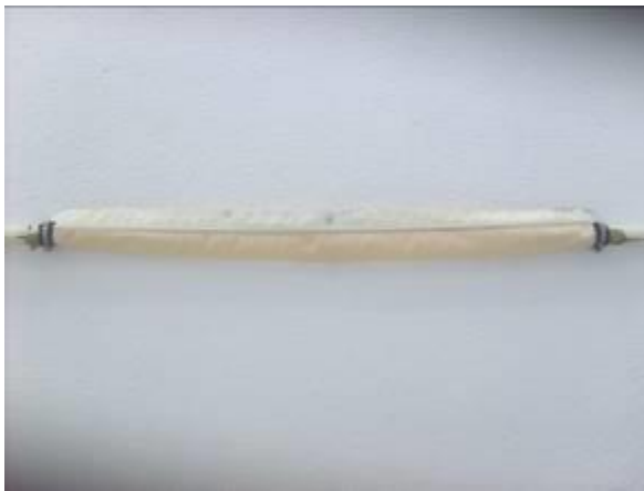
Figura 9 – Material Poroso Constituído de Tecido de Filtração.
