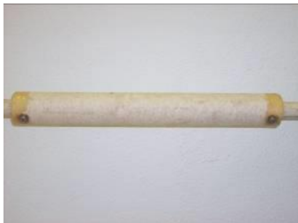
Figura 8 – Material Poroso Constituído de Fibras de Polipropileno.
